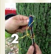
**Paso 3:** Apriete el nudo para que el extremo largo de la línea de tirada pueda soportar el peso.
